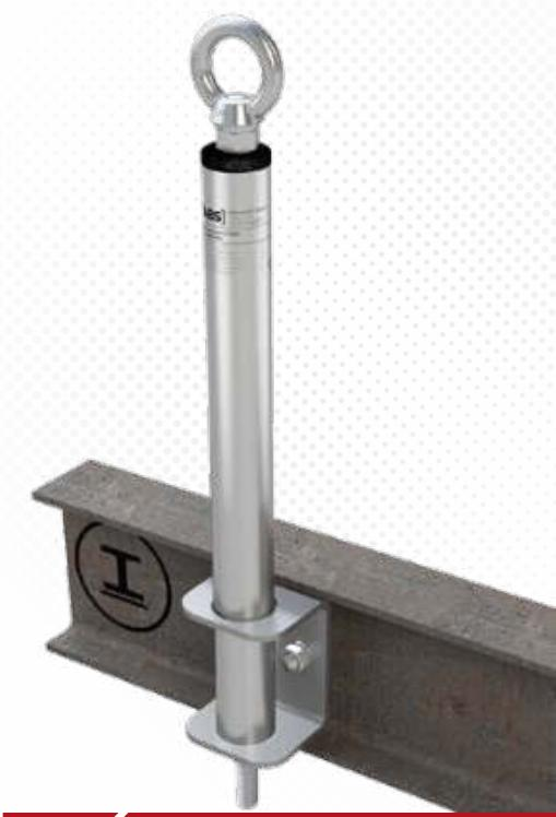
>>> Edelstahl-Anschlagpunkt ( $\varnothing$  16mm) mit Stützrohr ( $\varnothing$  42mm) für Stahl, seitliche Montage mit Winkelplatte. 2 Gewindestangen (250mm) werden durch Bohrlöcher gesteckt und mit Muttern gekontert. Inkl. Befestigungsset.
