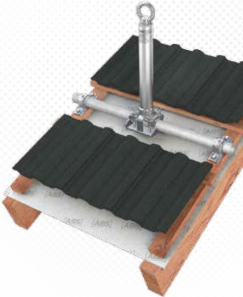
>>> Edelstahl-Anschlagpunkt für Holzsparren, mit verschweißtem Stützrohr ( $\varnothing$  42mm) und Querrohr. Stützrohr in 2 Längen erhältlich (300 o. 400mm). Einfache Abdichtung mit Antennenriegel (nicht im Lieferumfang). Befestigung am Untergrund mit 4 Edelstahlschrauben. Inkl. Befestigungsset.
