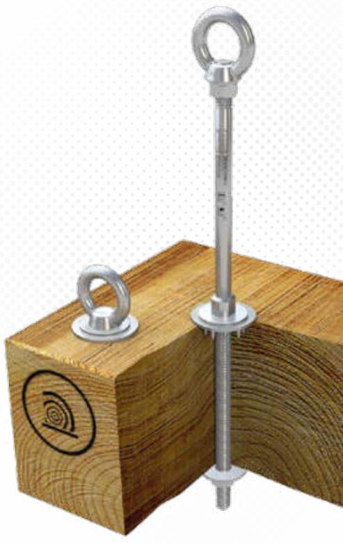
>>> Edelstahl-Anschlagpunkt ( $\varnothing 16\text{mm}$ ) für Holz, nach Bohrung durch den Balken gesteckt und mit einer Mutter gekontert. Mit und ohne Überstand erhältlich. Inkl. Befestigungsset.
