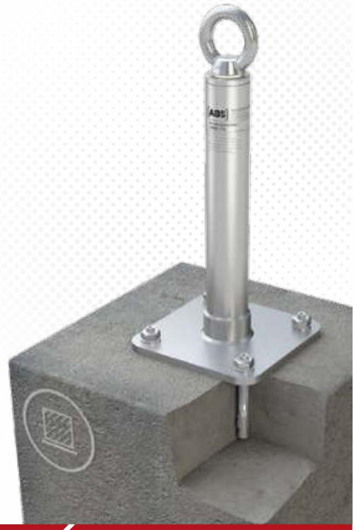
>>> Edelstahl-Anschlagpunkt für Beton, mit stärkerer Grundplatte (150 x 150mm) und verschweißtem Stützrohr (Ø 42mm). Zum Abseilen von 1 Person geeignet. Einfache Befestigung mit 4 Einschlagdübeln. Inkl. Befestigungsset aus Edelstahl.
