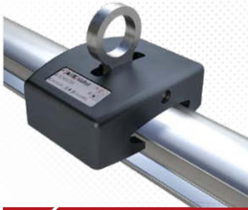
>>> Gleiter aus hochfestem Aluminium und Edelstahl für Schienensicherungssystem ABS AluTrax. Besonders gute Gleiteigenschaften durch kugelgelagerte Rollen. Schienensicherungssystem ABS AluTrax sichert bis 3 Personen zeitgleich (1 Person je Gleiter).
