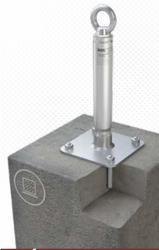
>>> Edelstahl-Anschlagpunkt für Beton, mit Grundplatte (150 x 150mm) und verschweißtem Stützrohr (Ø 42mm). 4 Ankerstangen werden mit Verbundmörtel WIT-VM-250 (ZU-1000) im Beton befestigt. Für nicht aufgeführt Betongüten erfolgt der Nachweis über Zugversuche. Inkl. Befestigungsset aus Edelstahl.
