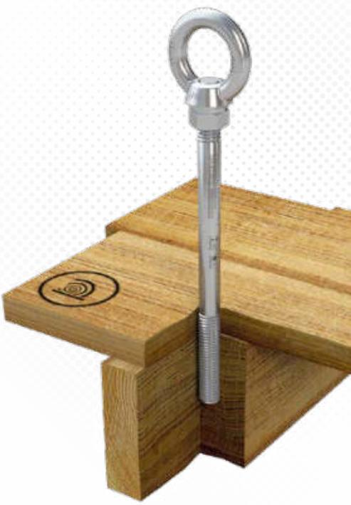
>>> Edelstahl-Anschlagpunkt ( $\varnothing 16\text{mm}$ ) für Holz. Wird nach Vorbohrung direkt durch die Holzschalung in den Sparren geschraubt.
