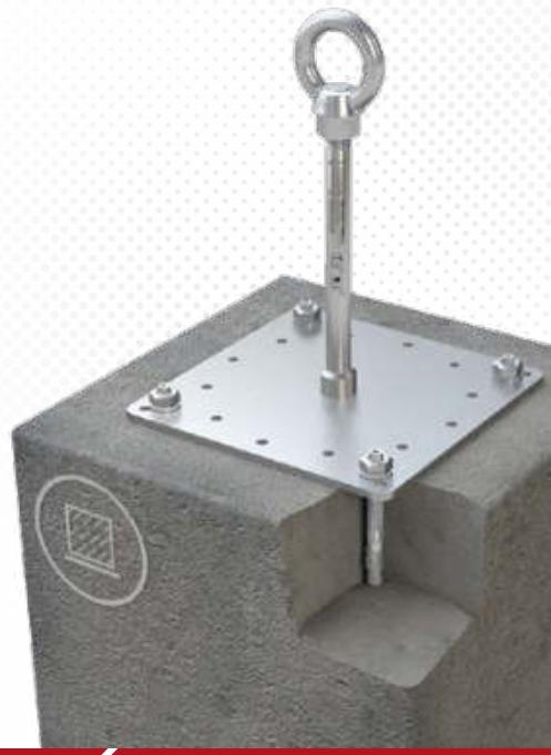
>>> Edelstahl-Anschlagpunkt ( $\varnothing$  16mm) für Beton, mit Grundplatte (200 x 200mm). Befestigung mit 4 Einschlagdübeln. Inkl. Befestigungsset aus Edelstahl.
