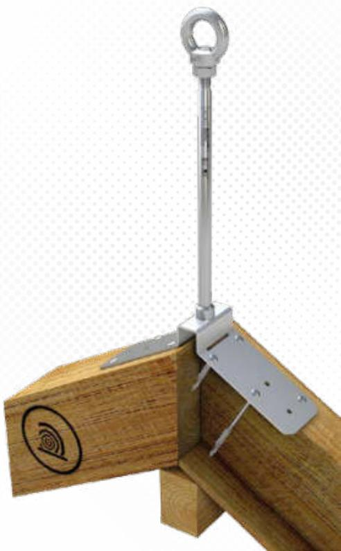
>>> Edelstahl-Anschlagpunkt ( $\varnothing$  16mm) für den Dachfirst, mit variabler Grundplatte. Kann von Hand an jede Dachneigung angepasst werden. Mit 8 Edelstahlschrauben im Dachsparren befestigt. Inkl. Befestigungsset.
