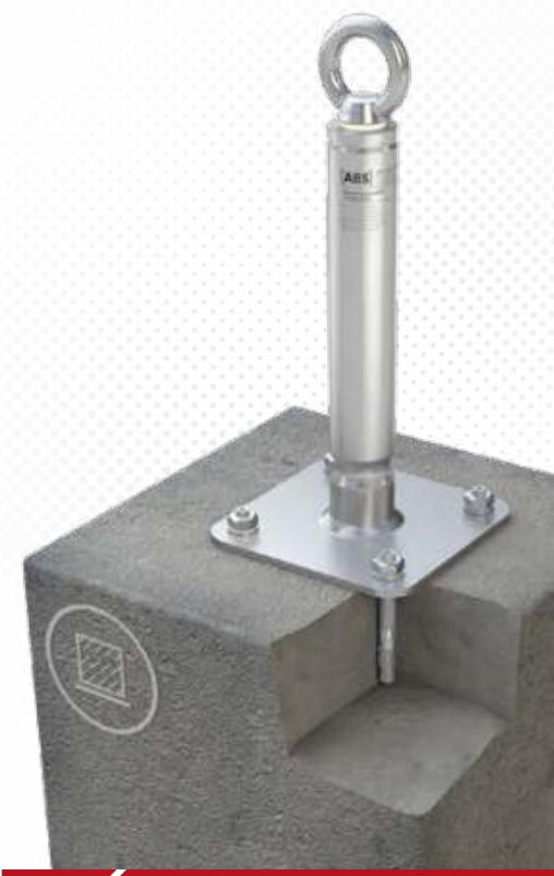
>>> Edelstahl-Anschlagpunkt für Beton, mit Grundplatte (150 x 150mm) und verschweißtem Stützrohr (Ø 42mm). Einfache Befestigung mit 4 Einschlagdübeln. Sondermaße auf Anfrage. Inkl. Befestigungsset aus Edelstahl.
