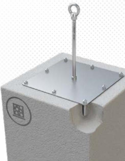
>>> Edelstahl-Anschlagpunkt ( $\varnothing 16\text{mm}$ ) für Leichtbeton/Porenbeton, mit Grundplatte (370 x 370mm). 8 Ankerstangen werden mit Verbundmörtel WIT-VM-250 (ZU-1000) im Beton befestigt. Inkl. Befestigungsset aus Edelstahl.
