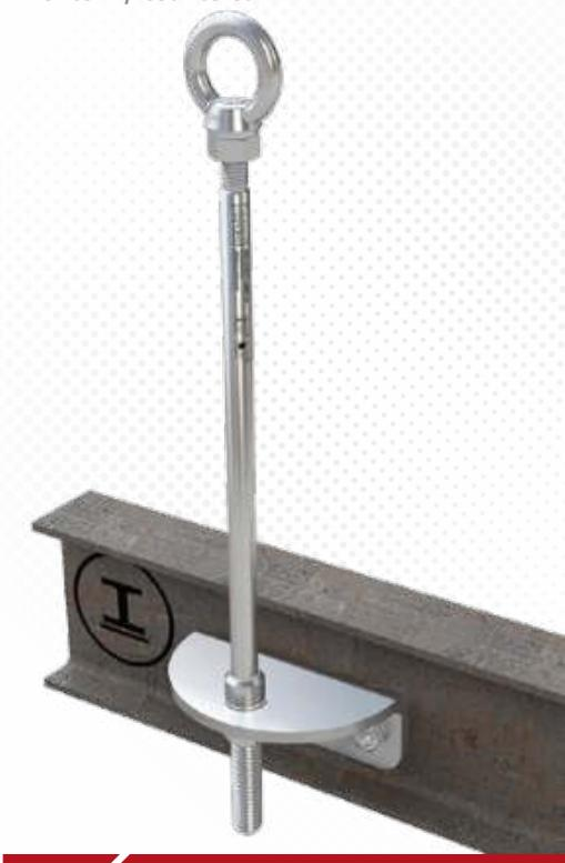
>>> Edelstahl-Anschlagpunkt ( $\varnothing$  16mm) für Stahl, seitliche Montage mit Winkelplatte. 2 Gewindestangen (250mm) werden durch Bohrlöcher gesteckt und mit Muttern gekontert. Inkl. Befestigungsset aus Edelstahl.
