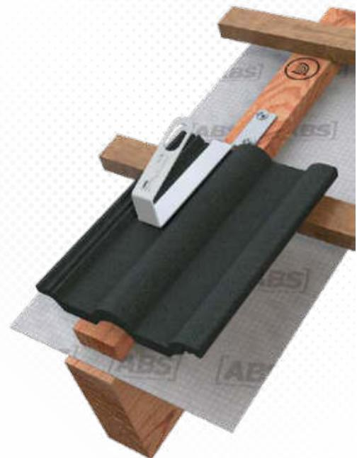
>>> Edelstahl-Sicherheitsdachhaken für Ziegeldächer im preislichen Einsteigersegment, mit gekröpftem Holm zur Überbrückung der Dachlattung. Befestigung mit 2 Edelstahlschrauben durch Konterlattung im Sparren. Inkl. Befestigungsset.
